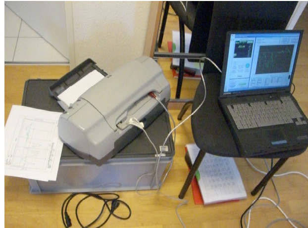
Abb. 6: Um die Messung im Messraum nicht zu stören, wurden die Registriereinheit (Laptop) und der Drucker im Flur aufgebaut.
