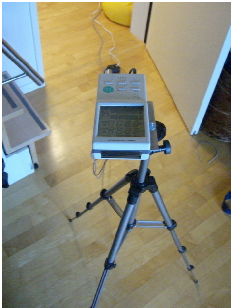
Abb. 5: Luftionen-Messgerät auf Stativ im Messraum (vgl. Abb. 2)
