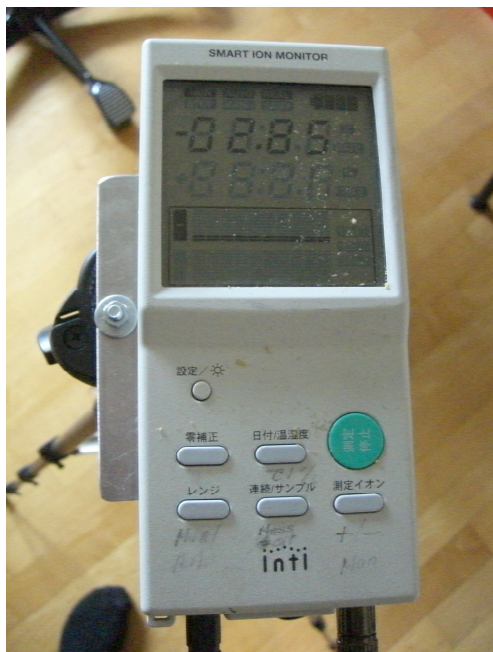
Abb. 7: Für die kontinuierliche Registrierung der Luftionen wurde der Smart Ion Monitor verwendet.
