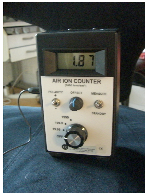
Abb. 8: Für vergleichende Einzelmessungen wurde der Luftionenzähler (Air Ion Counter) herangezogen.
